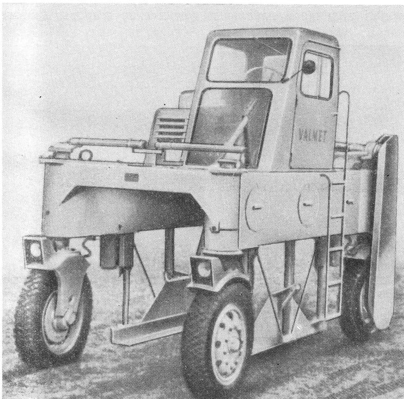
Рис. 41. Автомобиль Валмет 51В-60 с боковым расположением двигателя и одноместной кабиной
