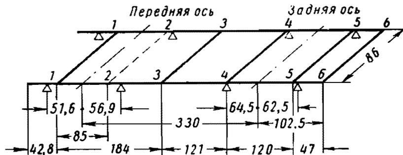
Фиг. 55. Расчетная схема рамы автомобиля ГАЗ-51.
