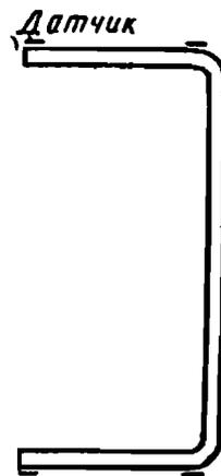
Фиг. 96. Схема расположения датчиков по сечению лонжерона.
