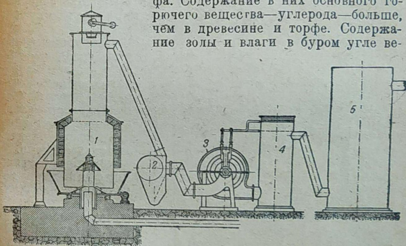
Рис. 24. Газогенераторная установка с улавливанием смолы: 1 — генератор со швельшахтой, 2 — водяной затвор и коллектор, 3 — смолоуловитель системы Тейсена, 4 — каплеуловитель, 5 — скруббер
