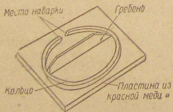
Рис. 1. Приспособление для наварки поршневых колец
