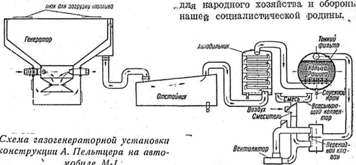
Двигатель снабжен головкой блока со степенью сжатия 6,4. На месте карбюратора установлен смеситель. Всасывающий коллектор имеет изоляцию от подогрева, так как рабочая газозоодушная смесь в подогреве не нуждается.
