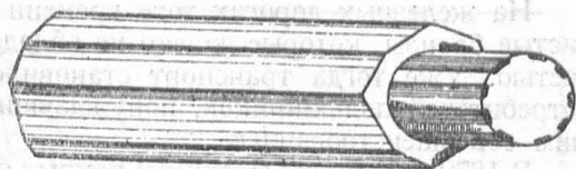
Рис. 5. Деревянный вал с цапфой, армированной железом для уменьшения износа. Середина XVIII в.
