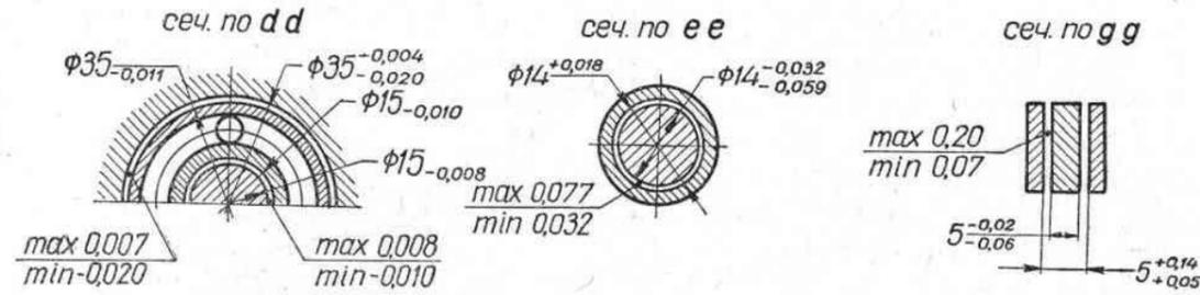
Биение поверхностей Y на радиусе 19 мм при установке на шлицы - не более 0,05 мм.
