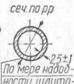
По мере надобности шлифовать на два размера:  $\phi 20^{-0,05}$  или  $\phi 20^{+0,05}$
