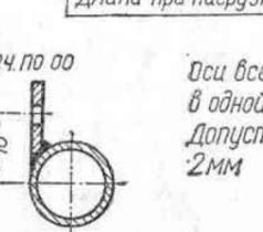
Обеспечить плоскость, зачистив наплывы сварочного шва
