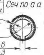
Допустимый зазор в месте наибольшего просвета по торцу не более 0,1 мм
